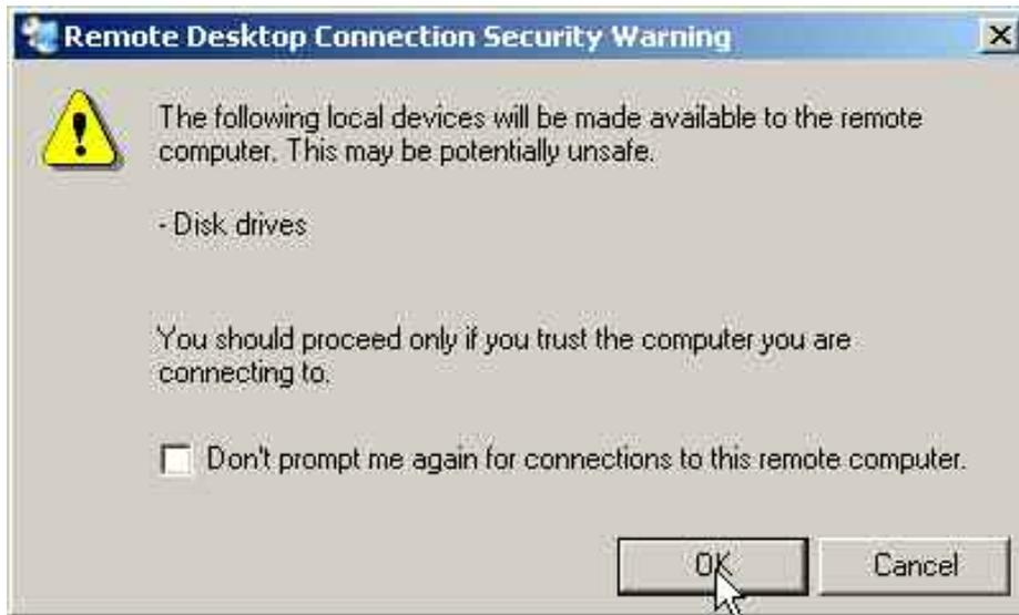
9. Pulsar **OK** para confirmar el mensaje. Tras unos segundos, se muestra la pantalla del R&S FSL. Si la aplicación del R&S FSL se muestra en la pantalla inmediatamente después de activar la conexión, no es necesario apagar y reiniciar el equipo.
