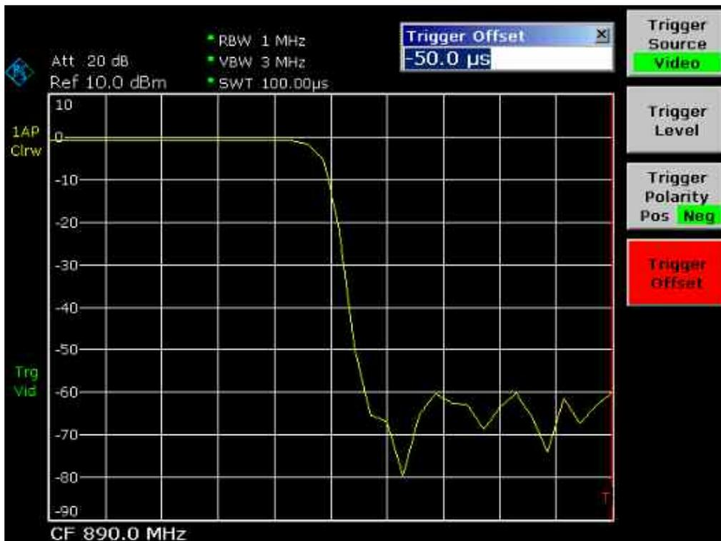
Fig. 5–11 Flanco de bajada de la ráfaga GSM con alta resolución temporal
