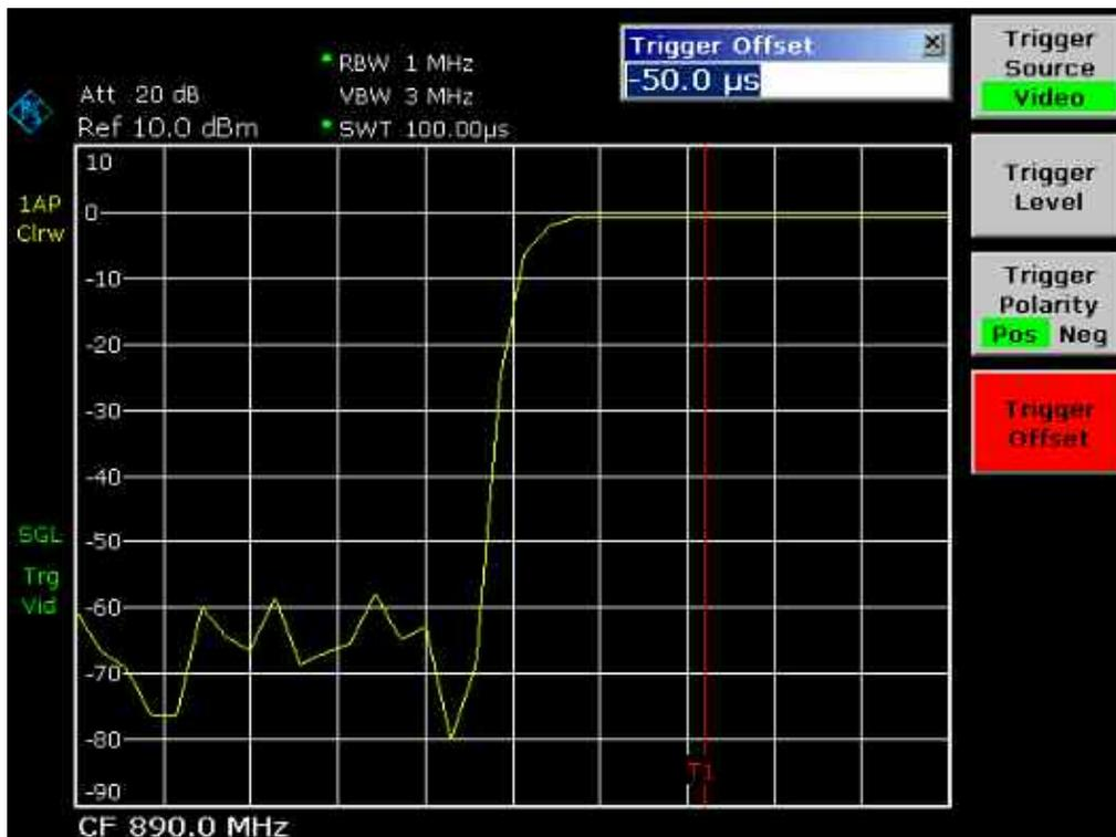
Fig. 5–10 Flanco de subida de la ráfaga GSM con alta resolución temporal
